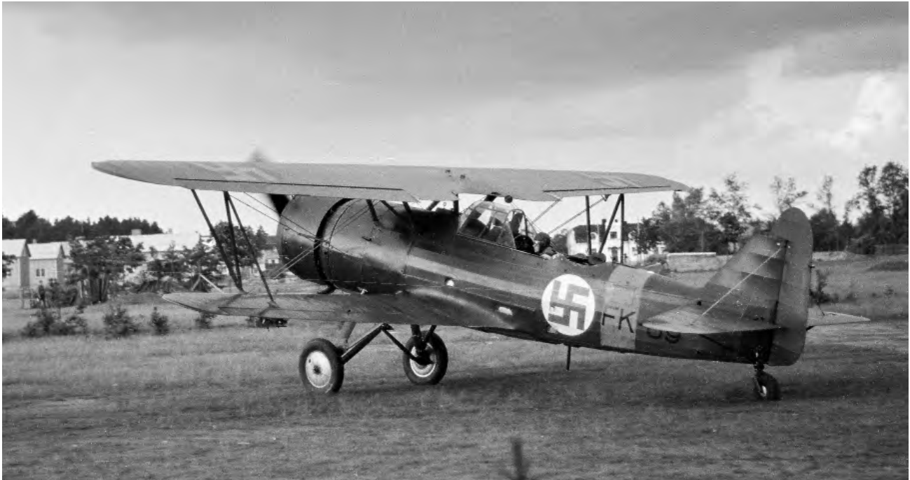
Fokker C.X (FK-89) Lappeenrannan kentällä jatkosodan alussa. Rungon kansallisuustunnuksen alapuolella näkyy riippuantennin läpivientiputki. (SA-kuva)
