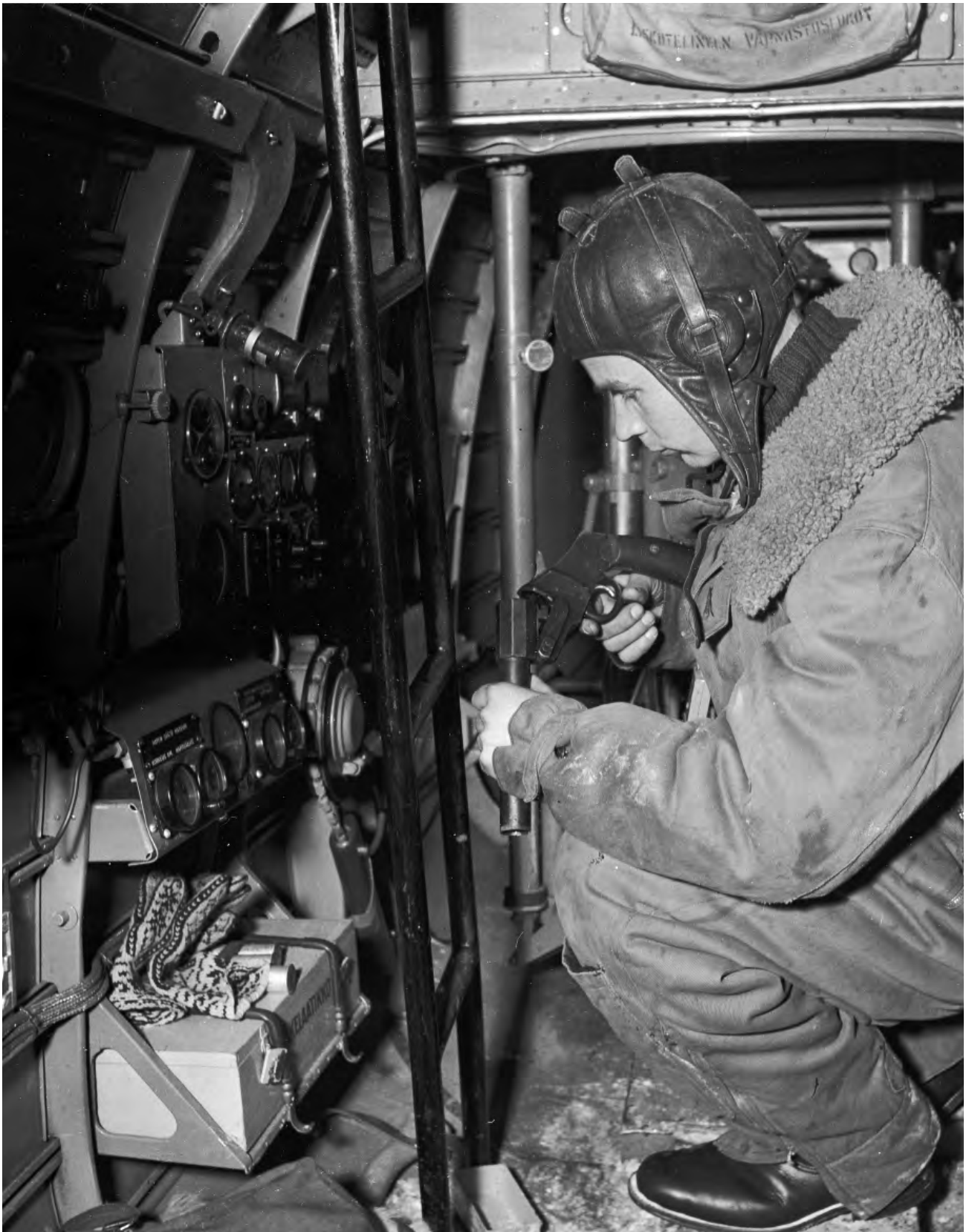
Lentolaivue 44:n alikersantti Lauri Lehtomäki tarkastelee Hebel-valopistoolia ykkössarjan Blenheimin (BL-115) takarungossa vuoden 1942 lopulla. Vaikka kaikille tarvikkeille oli omat kiinnityspisteensä, valopistoolin patruunat on tiukattu lääkelaatikon kahvan alle. Ykkössarjassa radion alkuperäinen sijoituspaikka oli keskirungossa kuvaajan selän takana. Koneelle sattui vuoden 1941 marraskuussa laskuvaurio, jonka korjauksen yhteydessä Marconi-asema siirrettiin konekivääritornin taakse. Miehen edessä, mittaripaneelin takana näkyy käsin kelattava riippuantenni ja lyijypainoketju, jonka tehtävä oli painaa antennia pystyasentoon ja vakauttaa sen lentoa. Kun radio ja antenni siirtyivät koneen peräosaan, antennivaijeri saattoi suurilla nopeuksilla joutua pyörivään liikkeeseen ja tarttua kannukseen. Kuvan antennilaite on alkuperäistä taaksepäin kallistettua mallia. Lämpivientiputkea muutettiin sivulle kallistetuksi kevästä 1942 lähtien ja saatiin antennivaijeri kauemmas koneen rungosta. Lyijypainoa ja kuparivaijeria korvattiin saksalaismallisella virtaviivaisella painolla ja ohuemmalla teräsvaijerilla vuoden 1942 lopulta lähtien. Antennin ilmanvastus väheni ja se lensi pystymässä asennossa. Vara-antennissa käytettiin lyijyketjua, sillä sen pystyi pujottamaan lämpivientiputkesta ulos lennon aikana. (SA-kuva)
