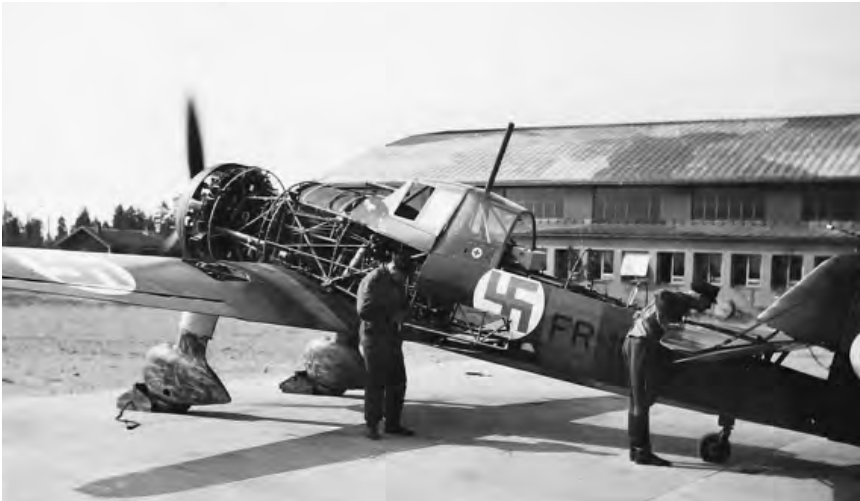
FR-100 oli korjattavana Kenttälentovarikko 1:ssä Utissa heinä–elokuussa 1941. Kone oli tuolloin Lentolaivue 14:n vahvuudessa, mutta pyrstön kahdeksikko on peruja Lentolaivue 32:n ajoilta. Fokkerin ohjaamon takaosassa, ylimenopukin ja lääkelaatikon takana, oli hylly johon radiolaitteet kiinnitettiin. Koneessa on paikoillaan vanhan P-12-17-aseman lähetin tai vastaanotin, mutta kuvan tarkkuus ei riitä tarkempaan tunnistamiseen. (Kansallisarkisto)
