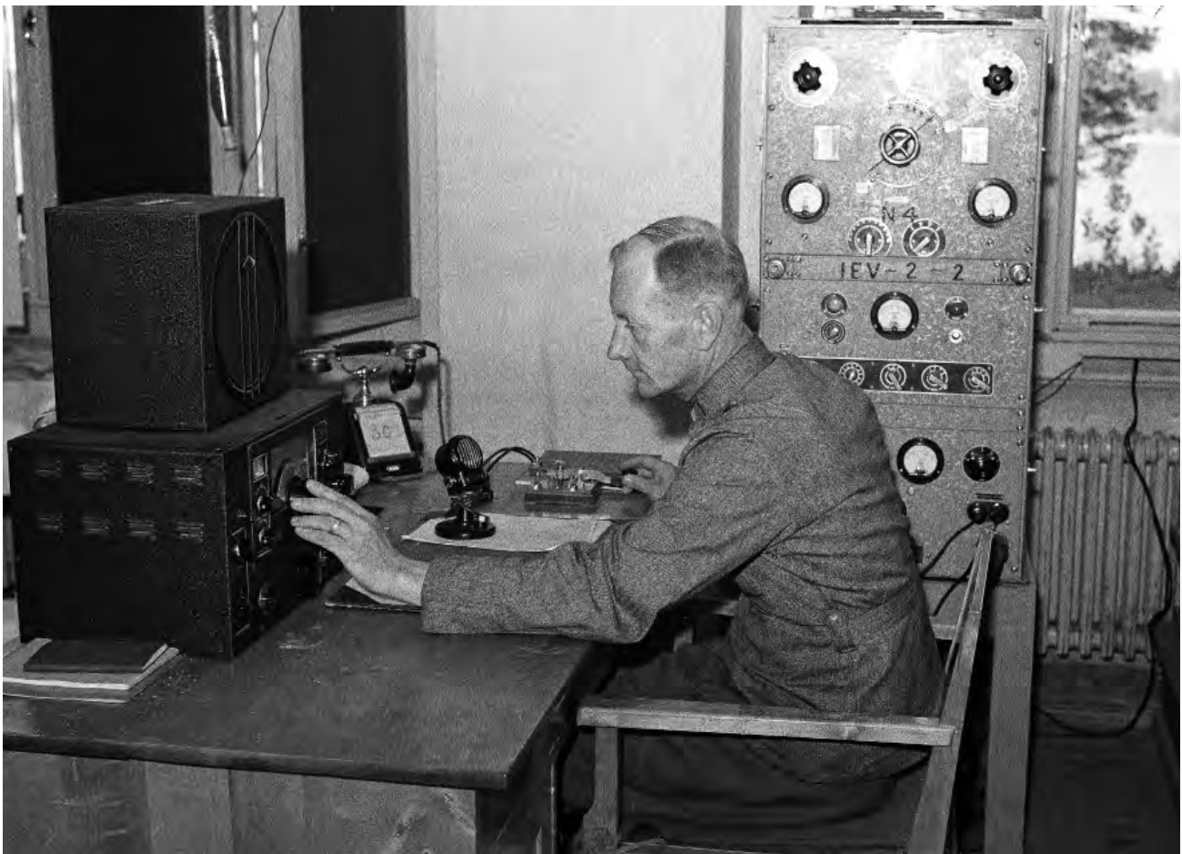
Väepeli Arvi Lemmetyinen Lentolaivue 14:n radioasemalla, joka sijoitettiin Lappeenrannan uudelle kasarmille Ratsastavan patterin tiloihin elokuussa 1941. A-600-lähettimen etupaneelissa näkyy esimerkki, miten IEV-tunnus ja uusi juokseva sarjanumero oli tarkoitus maalata keväällä 1941. Sodan syttyminen keskeytti hankkeen ja merkinnät tulivat vain muutamaisiin laitteisiin. Vastaanottimena on National NC-100A. (SA-kuva)
