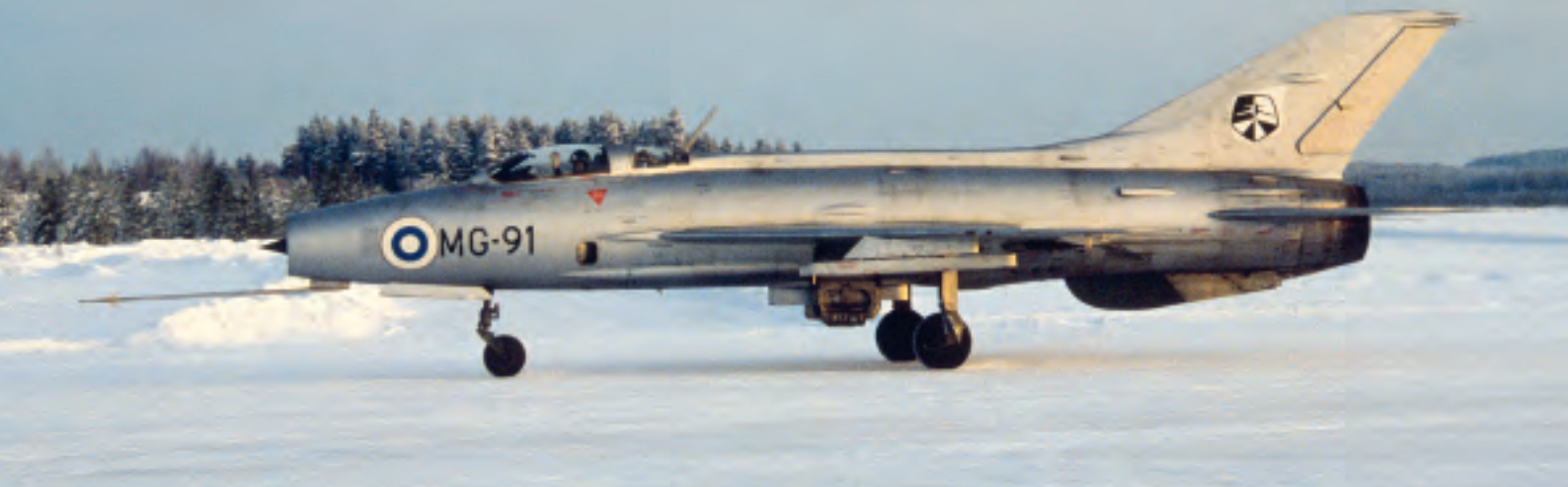
Tiedustelulentolaivueen MiG-21F-13 MG-91 rullaa huoltokoelennon päätteeksi Hallissa tammikuussa 1985. MG-91 sai perushuollossa Neuvostoliitossa tasaharmaan maalauksen. Rullatessa ohjaus tapahtuu pääpyörien jarruilla nokkapyörän ollessa vapaasti kääntyvä. (© Jyrki Laukkanen)
