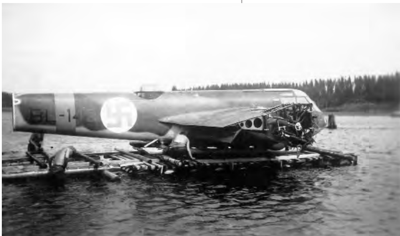
Kolmoslentueen BL-142:n runko hinataan lautalla kovalle maalle. Ylikersantti Reino Malin teki pakko-laskun suolle Ilomantsissa molempien moottoreiden pysähtyessä matkalennolla 1.7.43.
