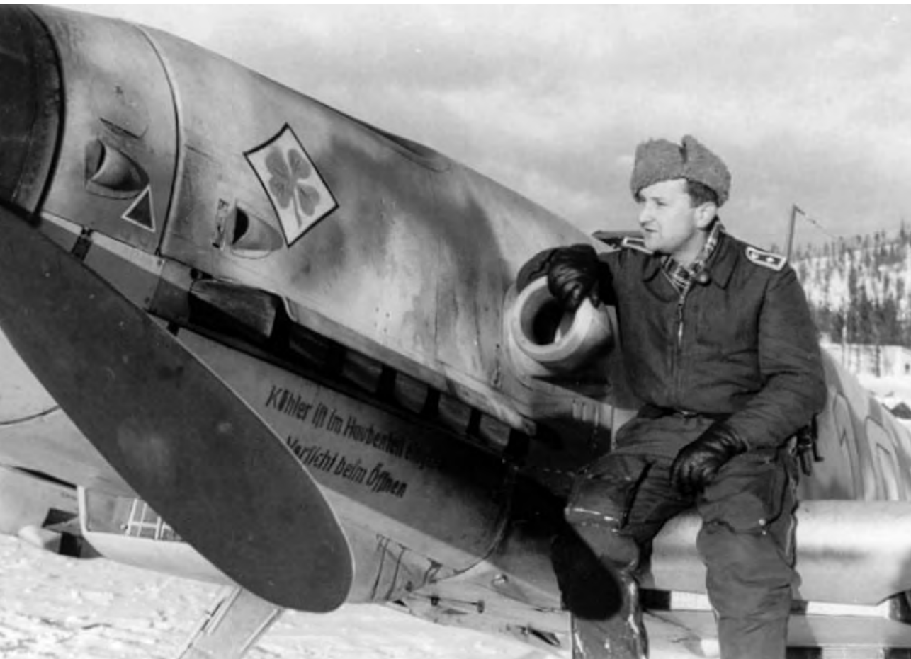
Vääpeli Hans Döbrich istuu upouuden Bf 109 G-2/R6 -koneensa siivellä Alakurtissa 1943. R6-varustus tarkoitti kahta 20 millimetrin MG 151 -tykkiä siipien alla.
