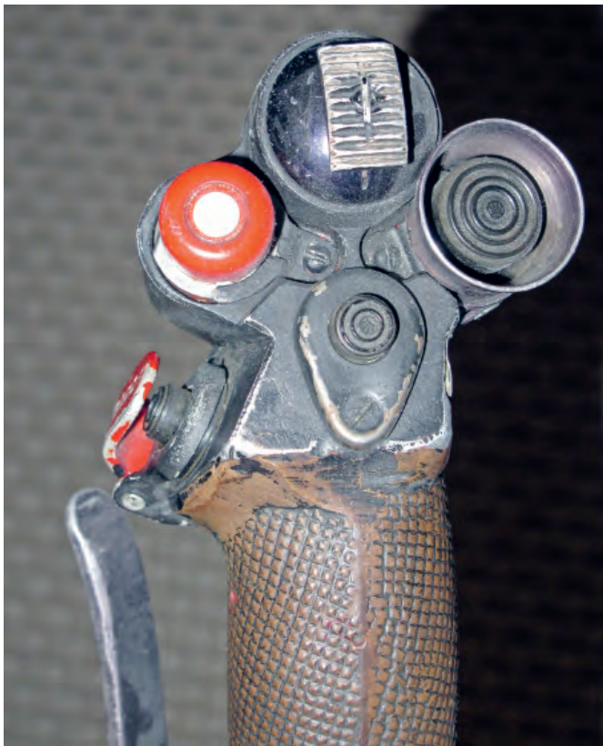
MiG-21BIS-koneen ohjaussauvan yläpää. Nappi punaisen suojakan- nen alla on ohjusten laukaisu, pieni musta keskellä on tutkan lukitus/ tähtäimen vaimennus, suuri punainen on autopilotin irtikytkentä, suuri musta on autopilotin oikaisutoiminnan kytkentä ja peukalokyt- kin keskellä on pituustrimmi. Jarrukahvan yläpää näkyy vasemmalla puolella.
