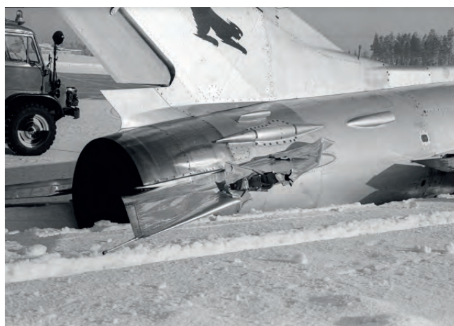
Yllä: MG-61:n oikeasta laskutelineestä on telinevarresta irronnut työsylinteri. Alla: Katkennut oikea laskuteline osui oikeanpuoleiseen vakaajaan rikkoen sen korjauskelvottomaksi.
